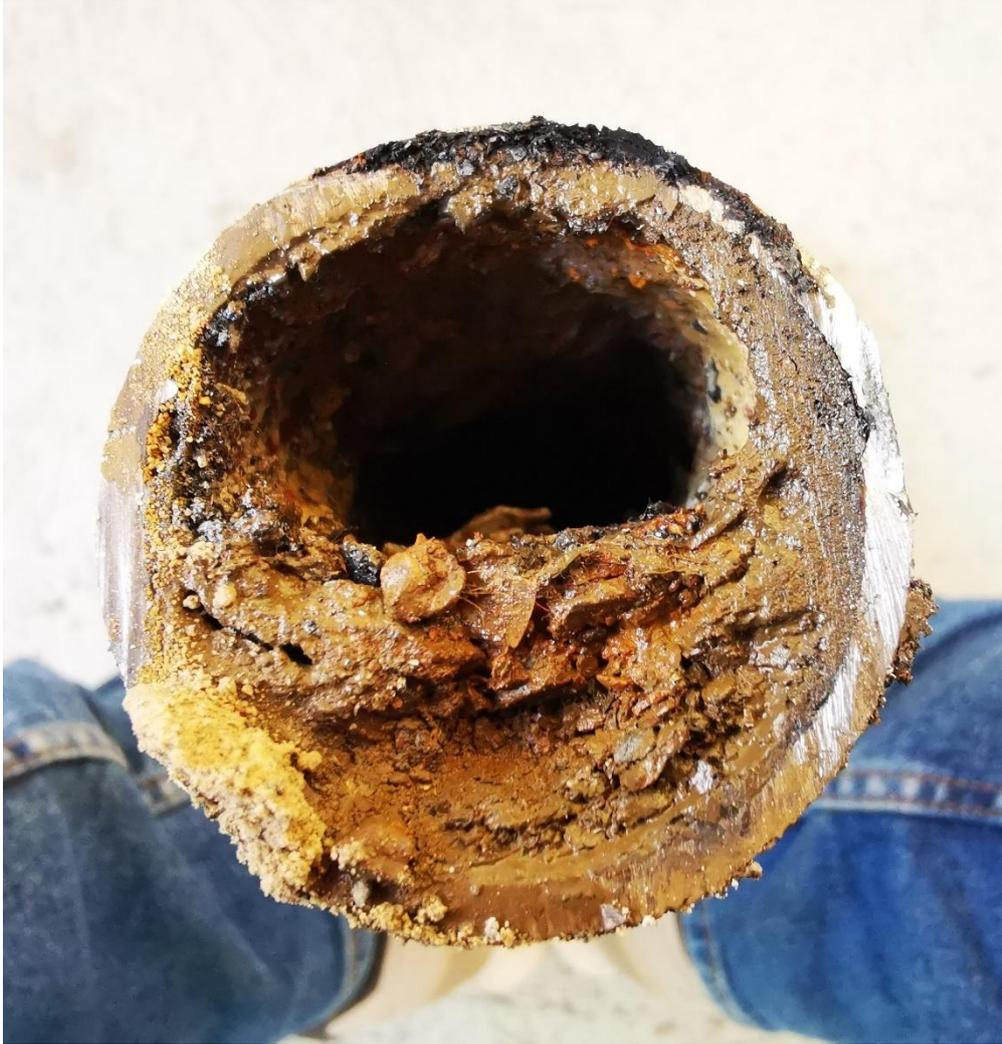
Badablauf 60% verstopft, Rohr oben schwarz oxidiert, Rohrbruch mit Wasseraustritt möglich
